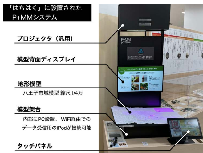
図1 使用した高精度ポータブル型P+MMシステムの構成
