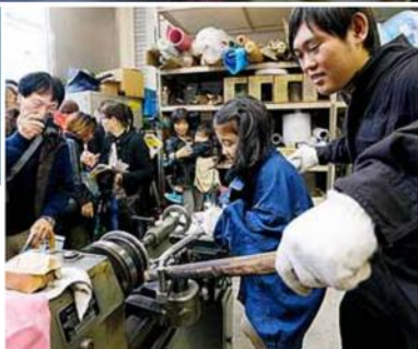
④「おおたオープンファクトリー」の「仲間回しラシー」で「へら絞り」と呼ばれる金属加工を体験する女の子。棒状の工具を押し当てると、丸いステンレス板がぐにゃりと曲がり、ミニフライパンの本体になった。⑤参加者が作ったフライパン。11月29日、東京都大田区。写真はいずれも関田航撮影
