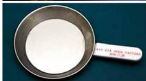
④「おおたオープンファクトリー」の「仲間回しラシー」で「へら絞り」と呼ばれる金属加工を体験する女の子。棒状の工具を押し当てると、丸いステンレス板がぐにゃりと曲がり、ミニフライパンの本体になった。⑤参加者が作ったフライパン。11月29日、東京都大田区。写真はいずれも関田航撮影
